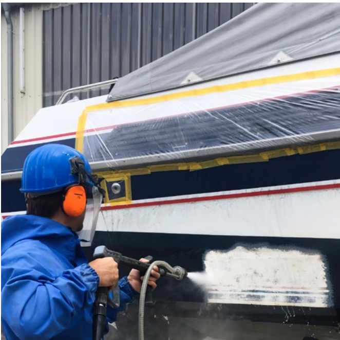
Entfernung des Altanstrichs für die Sanierung eines Schiffes Removal of the old paint for the renovation of a ship Élimination de peintures anciennes pour la rénovation d'un bateau
