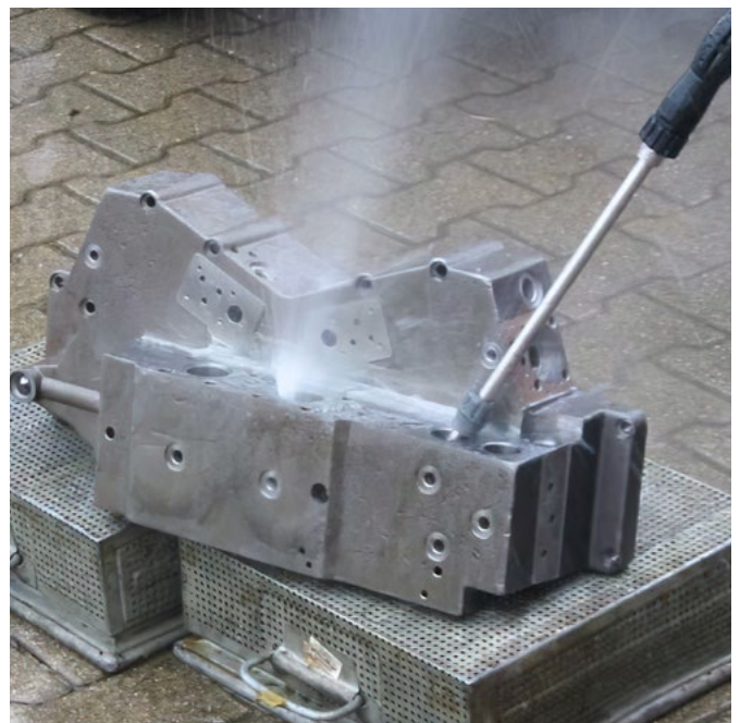
Reinigung von Formen Cleaning molds Nettoyage des moules
